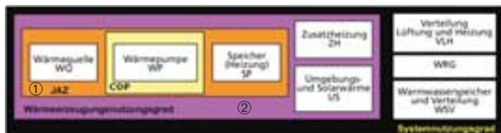
Figure 2 Limites du bilan pour le calcul des trois paramètres caractéristiques. Pour les détails, voir le texte.
