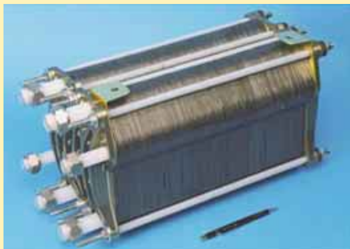
"Stack" PEFC de 100 éléments refroidis à l'eau et de surface active 200 cm 2 chacun, pour le projet de démonstration d'une pile à combustible de 6 kW.
