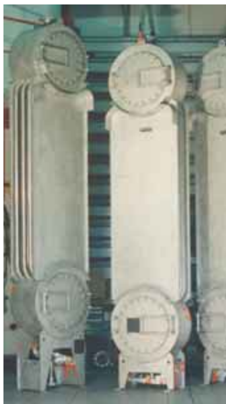
Échangeurs de chaleur étudiés à l'aide de l'installation PANDA, avant leur montage dans le réservoir d'eau.
