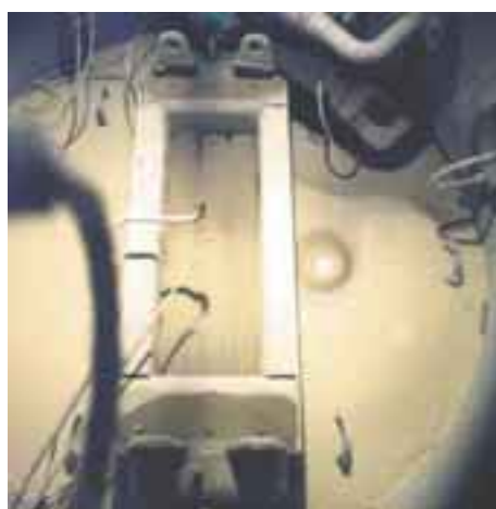
Dépôts d'aérosols sur l'échangeur de chaleur testé.
