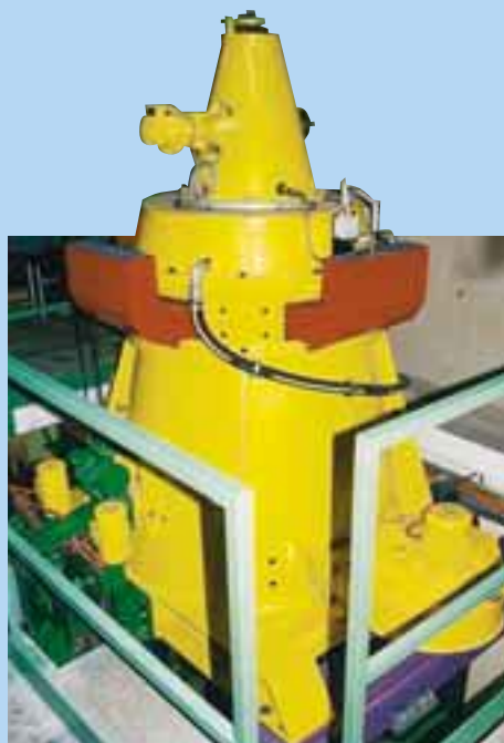
Génératrice à courant continu et vitesse variable, permettant de modifier les conditions hydrauliques, avec un accouplement direct sur l'arbre de la turbine.
