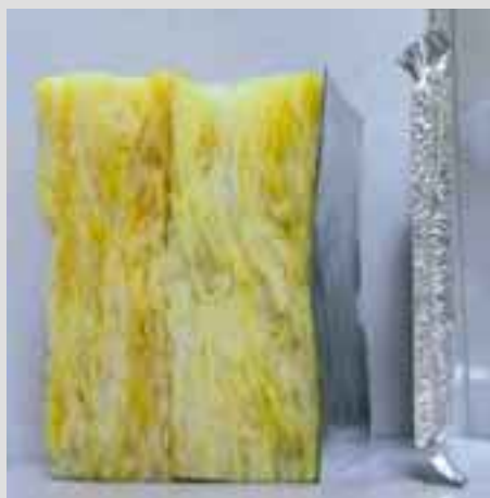
Laine minérale et PIV (à droite), une comparaison éloquentes des épaisseurs de paroi.
