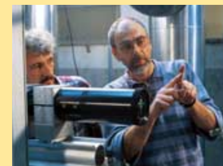
Mesures de vitesse dans une chambre de combustion à turbulences à l'aide d'un laser optique, à l'Université de Stuttgart dans le cadre d'un projet européen. (Photos: H. Grieder, Langenbruck)
