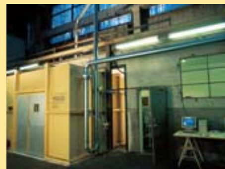
Cellule calorimétrique et tunnel de dilution des gaz de fumée, deux équipements phares du Laboratoire de l'énergie de demain. Elles permettent la mesure précise de la chaleur dégagée par une chaudière (à gauche).
