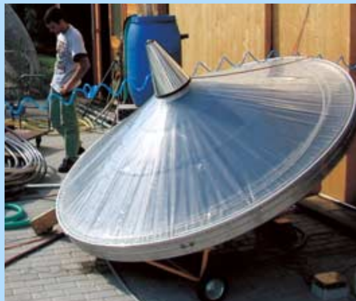
"SunPulse", la machine Stirling à basse fréquence entraînée à l'énergie solaire, joue le rôle de pompe à eau.
