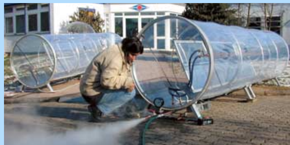
Destiné aux serres, "SolarEnvelope" concentre le rayonnement solaire et utilise la lumière diffuse pour la croissance des plantes. Ici, un dispositif d'essai.
