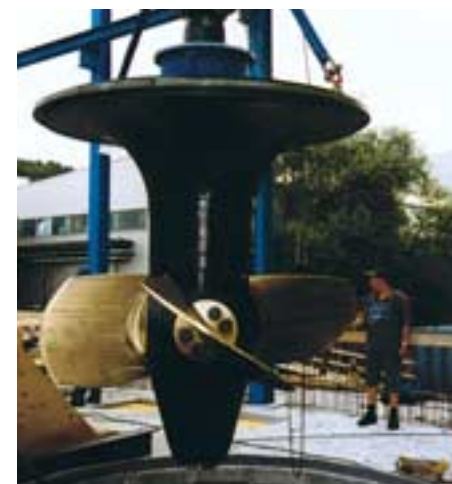
Roue à aubes avec aubes directrices réglables de la turbine Kaplan.
