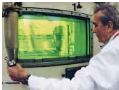
Im Hotlabor des PSI (oben) werden Brennstäbe auf materialtechnische Fragen hin untersucht. Bruchtests an einem Hüllrohrabschnitt (rechts).
