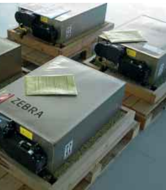
Zum Versand bereit: ZEBRA-Batterien stehen in unterschiedlichen Kapazitäten und Leistungen zur Verfügung und sind unterhaltsfrei.
