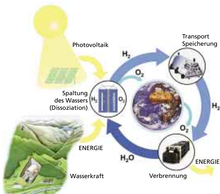
Wasserstoff-Kreislauf mit der Erzeugung durch erneuerbare Energien. (Grafik: Institut für erneuerbare Energie Schweiz, www.ifres.ch )
