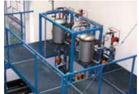
Prüfstand im Institut für Mess- und Regeltechnik (IMRT) der ETH Zürich für Sole-Wasser-Wärmepumpen. Hier werden Vergleichsmessungen der Pulsbreitenmodulations-Strategien durchgeführt.
