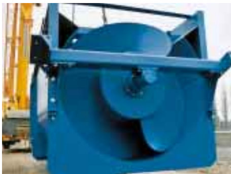
Die Wasserkraftschnecke hat bezüglich Wirkungsgrad, Unterhalt und Fisch-Abwanderung entscheidende Vorzüge. (Fotos: Th. Köhli)
