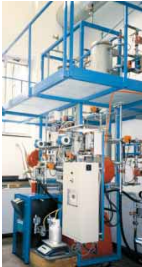
Prüfstand im Institut für Mess- und Regeltechnik (IMRT) der ETH Zürich für Sole-Wasser-Wärmepumpen. Hier werden Vergleichsmessungen der Pulsbreitenmodulations-Strategien durchgeführt.
