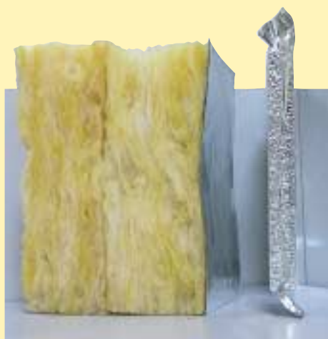
Dickenvergleich zwischen herkömmlichem Isolationsmaterial und VIP verdeutlicht den Vorzug dieser neuen Technik.
