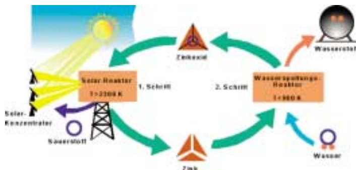
Thermochemischer Kreisprozess zur Gewinnung von Wasserstoff mit Hilfe von Zinkoxid.
