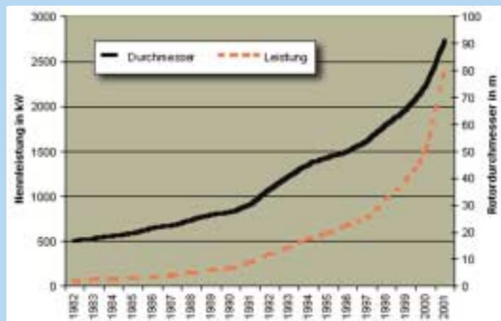
Entwicklung der Anlagengrößen (Rotordurchmesser und Nennleistung) in den letzten 20 Jahren. (Grafik: Bundesverband Windenergie Deutschland)
