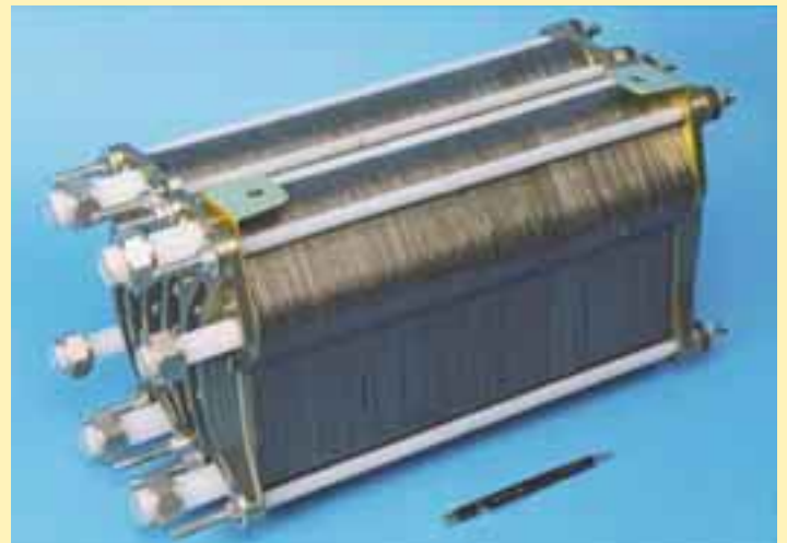
PEFC-Stapel mit 100 wassergekühlten Zellen und einer aktiven Fläche von je 200 cm 2 für das Demonstrationsprojekt einer 6-kW-Brennstoffzelle.
