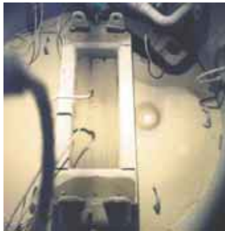
Aerosolablagerungen auf dem Wärmetauschermodell.
