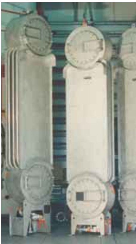
In der PANDA-Anlage untersuchte Wärmetauscher vor der Montage in den Wasser-vorlagen.
