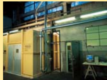
Kalorimeterraum und Abgas-Verdünnungstunnel im Labor für nachhaltige Energiesysteme. Hier kann die Wärmeabgabe einer Einzelfeuerung (links) exakt gemessen werden.
