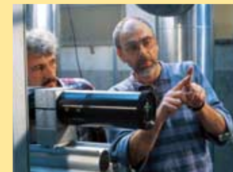
Laseroptische Geschwindigkeitsmessung in einer Wirbelbrennkammer durch die Universität Stuttgart im Rahmen eines europäischen Projektes. (Fotos: H. Grieder, Langenbruck)
