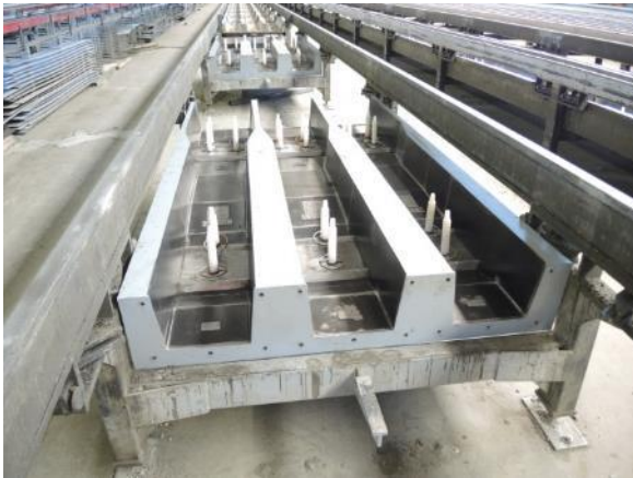
Abbildung 9-2: Einbau im Langbett der Schalungsmodelle B19 Hammerhead und Railbone
