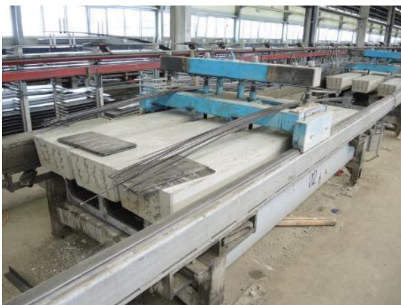
Abbildung 9-6: Zuschnitt und Abstützung der Schwellen vor dem Heben aus dem Langbett
