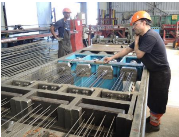
Abbildung 9-4: Vorspannung der Spanndrähte
