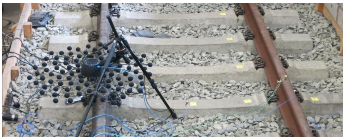
Abbildung 7-17: Messungen des Schwellenschalls mittels Mikrofonarray BionicM
