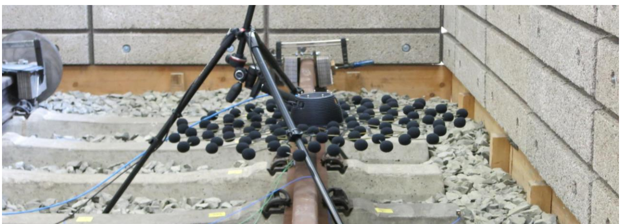
Anordnung der Mikrofonarrays am Testgleis
