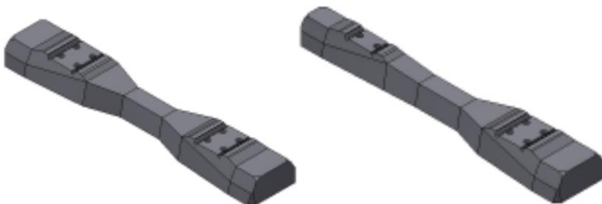
Abbildung 8-13: CAD-Modelle PROSE 02-2019: oben Rail-Bone- und unten Hammerhead-Betonschwelle
