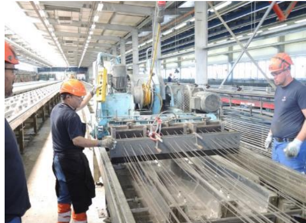
Abbildung 9-3: Einzug der Spanndrähte
