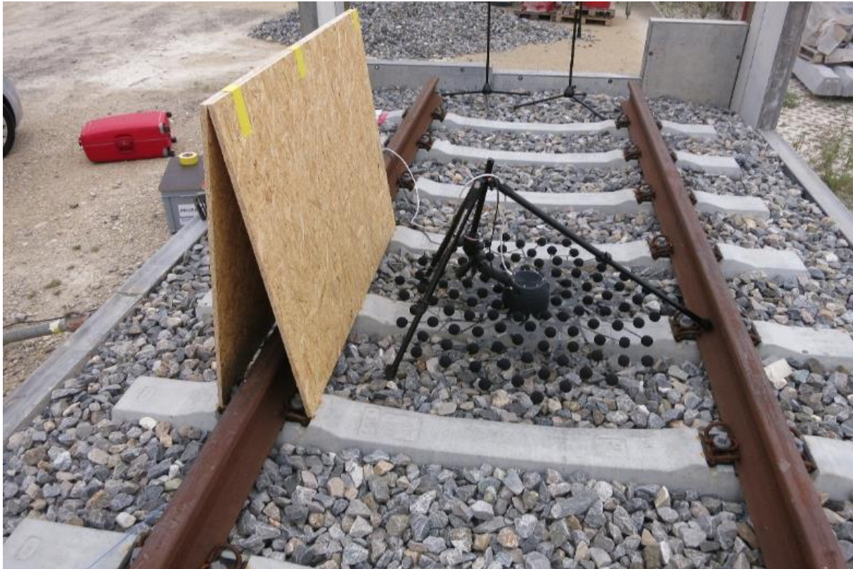
Teilabschirmung der Schiene bringt auch keine merkliche Verbesserung
