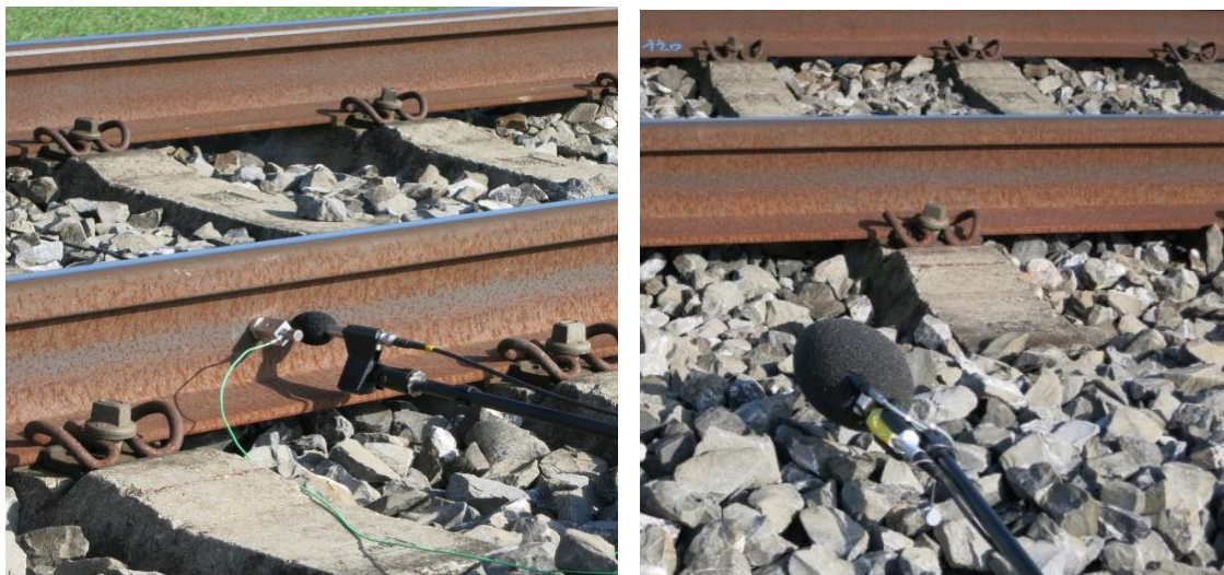
Abbildung 7-24: Messung Schienenschall über Schallintensitäten - zwei Verfahren (PROSE 2017)
