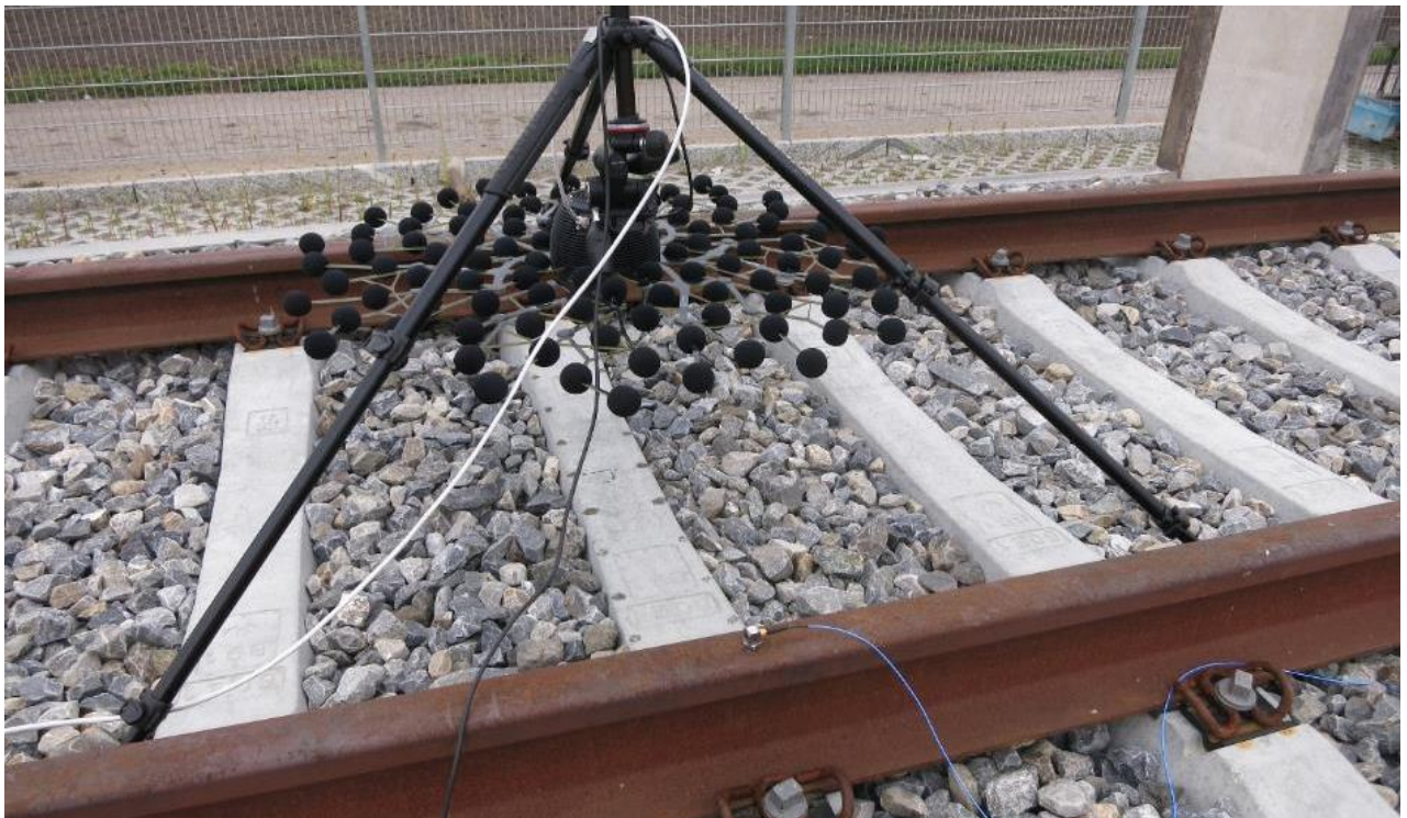
Messaufbau Mikrofonarray auf dem Testgleis in Müntschemier
