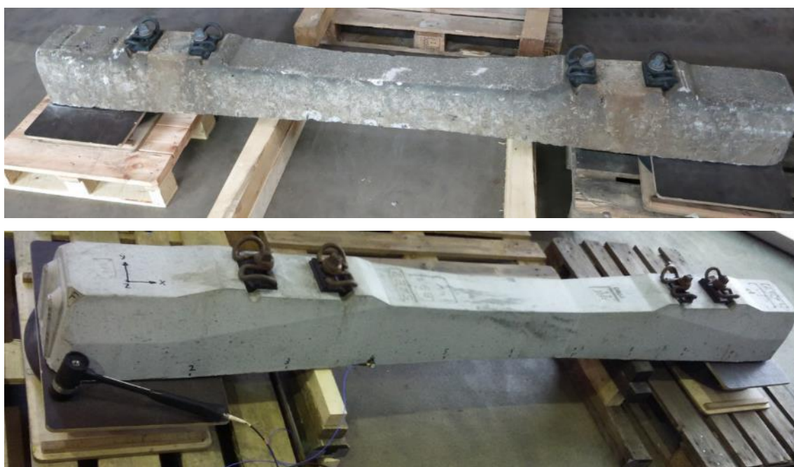
Abbildung 7-1: Betonschwellen für die Modalanalyse auf Gummireifen gelagert, B70 oben und B91 unten
