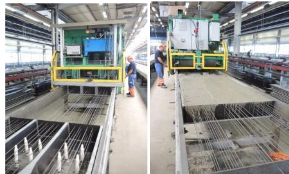
Abbildung 9-5: Betonieren der Schwellen
