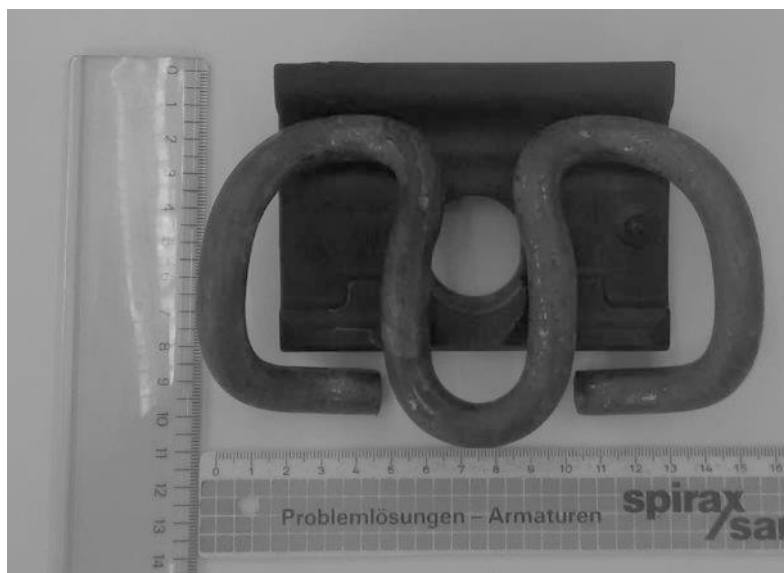
Abbildung 8-5: W14-Klemmung Standardbauteil B91 Oberbau SBB
