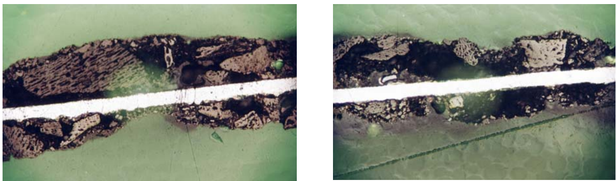
Figure 19: Teilchen in der Elektrode links Ausgangsbasis, rechts Teilchengrösse 10-60 \mu\text{m}
