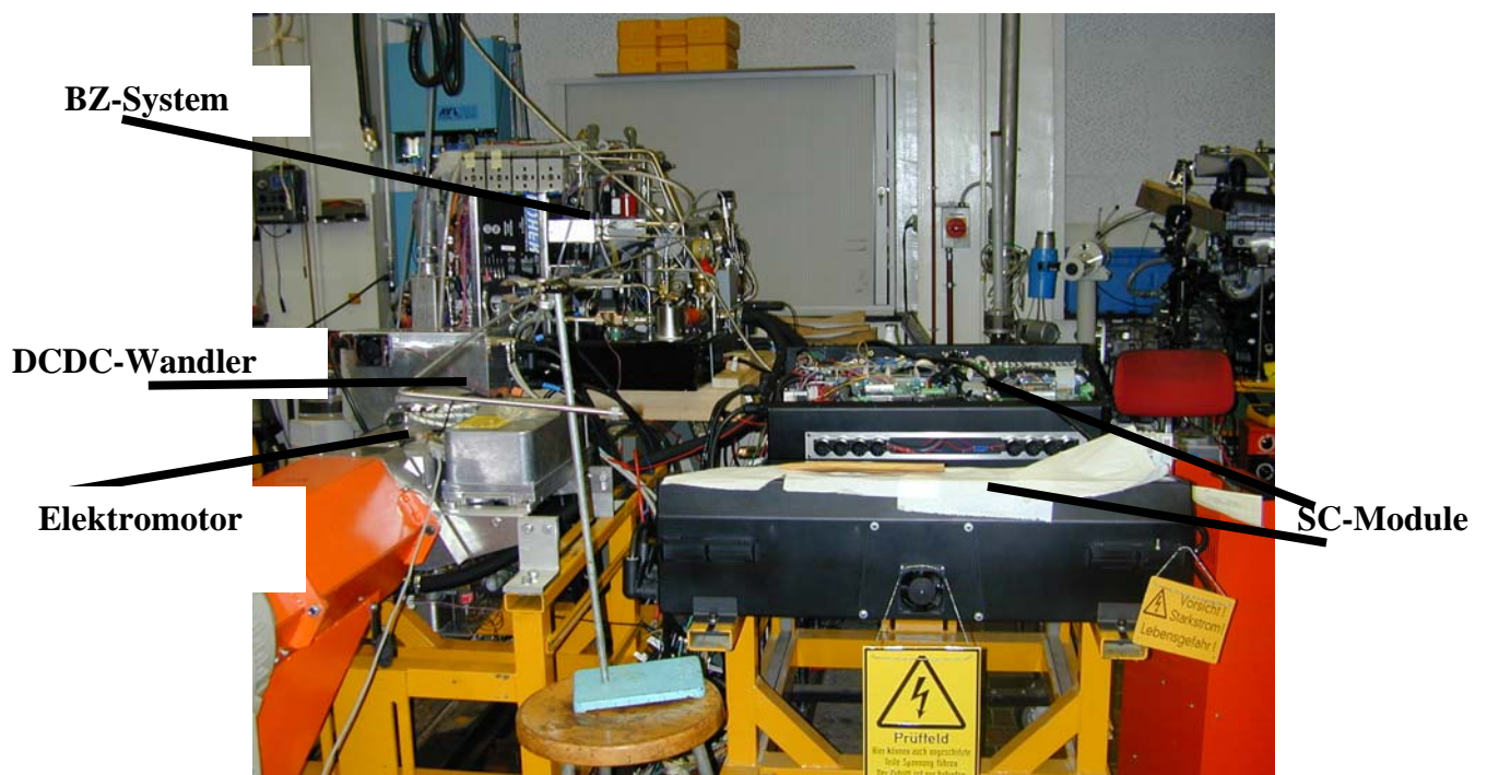
Figure 46: Ansicht des dynamischen Prüfstandes mit allen relevanten Komponenten des Antriebsstranges
