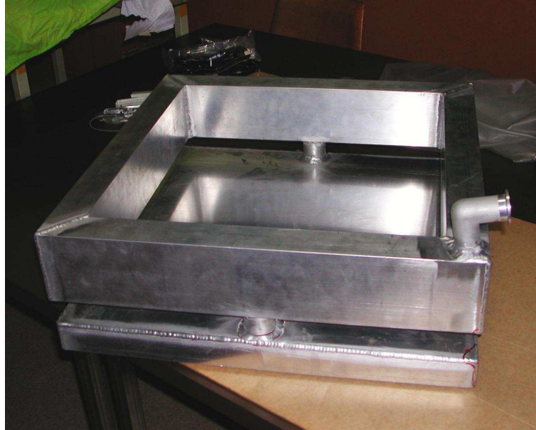
FIG. 8 – Vue de l'évaporateur auto-stockeur.
