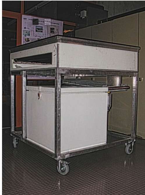
Fig. 4 : Le réfrigérateur solaire à adsorption dans son état actuel
