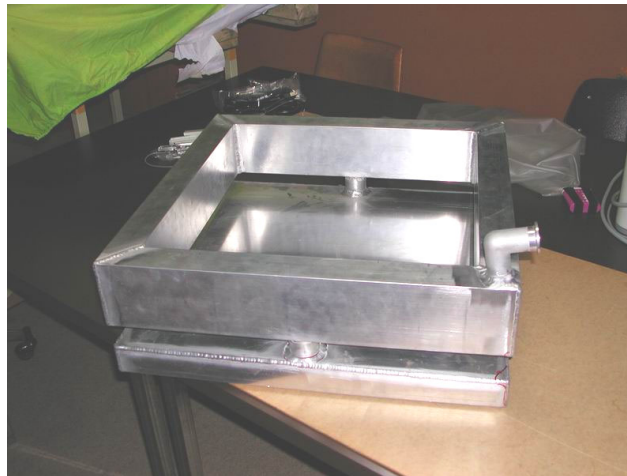
Fig. 5 : Retouches de soudures sur l'évaporateur en aluminium
