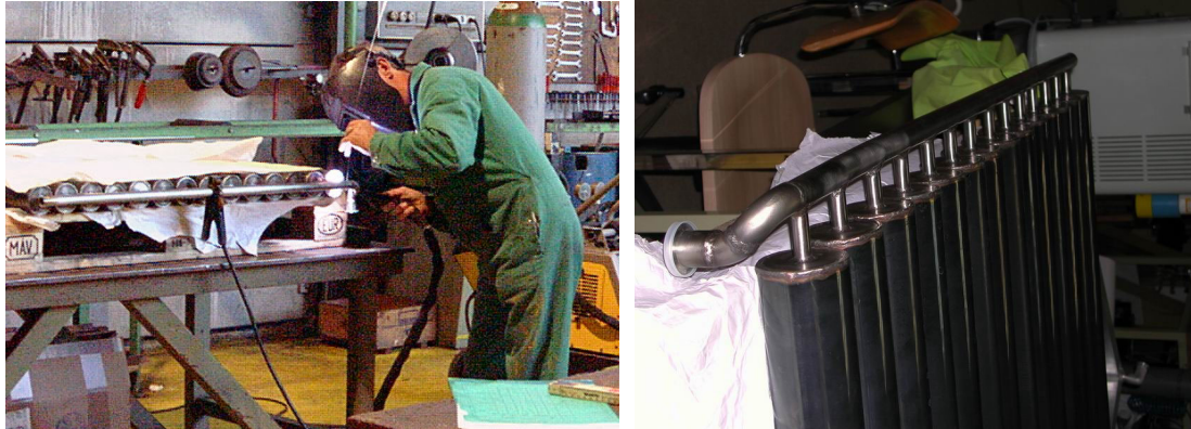
Fig. 3 : Fermeture des tubes remplis de silicagel puis soudage avec le collecteur.
