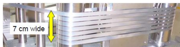
Fig. 3. Detail der Y-123 Band-Herstellung bei Superpower (USA)
