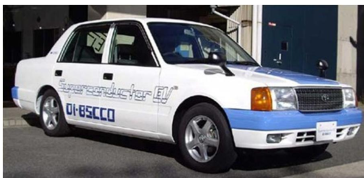
Fig. 9. Premiere: weltweit erstes durch einen supraleitenden Motor betriebenes Auto in Japan.
