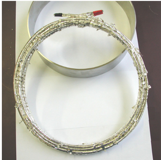
Fig. 2: Erstes Bi,Pb(2223) Kabel mit isotroper Stromdichte ( I_c vs. B ), mit I_c = 200 \text{ A} bei 77 K, bestehend aus 20 einzelnen, viereckigen Bi,Pb(2223) – Drähten (Hergestellt an der Uni Genf im Rahmen des BIG POWA Projekts (5th European Frame Program)).
