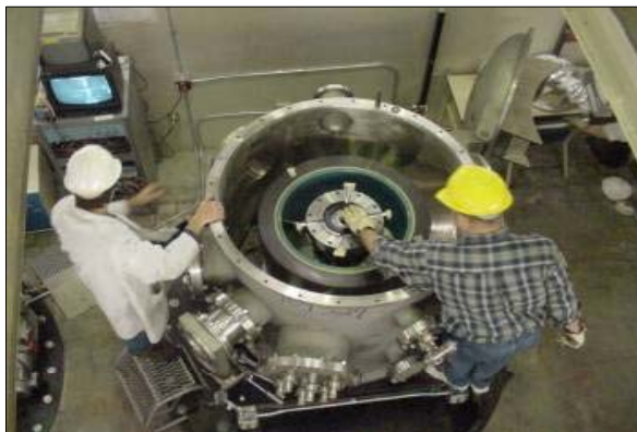
Supraleitendes Prototyp-Schwungrad von Boeing im Test (10 kWh/3kW, August 2002)
