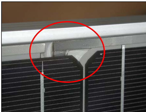
Bild 6-52: Das 1. Defekte Module der Testanlage. Leiterbahn und Laminat haben sich teilweise von der Zelle gelöst.
