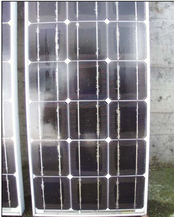
Bild 4-17: Von der HTA Burgdorf untersuchtes Arco Solar – Modul (Seriennummer 222 806). Deutlich zu erkennen die weissen Flecken in der Nähe der Leiterbahnen und die Hellfärbung sämtlicher Zellenränder. Die Delaminationen bewirken die Verschattung des Moduls und damit die Reduktion der möglichen Maximalleistung.
