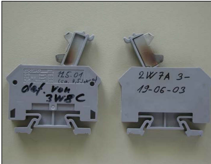
Bild 6-51: Defekte Trennklemmen der Testanlage, die durch zu hohe Übergangswiderstände unterbrochen wurden. Die thermisch Überlastung ist deutlich am überhitzten Kunststoff der Trennklemmen zu erkennen.
