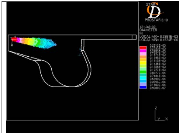
Abbildung 11 Flüssige Phase 1.2 ms nach Einspritzbeginn (dt 2 \mu\text{s} ) 185° KW
