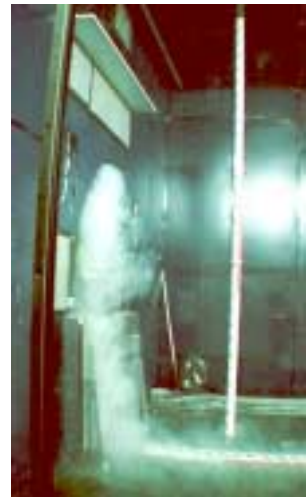
Figur 4-9: Die Eindringtiefe der Diskomfortzone wird bei der Anordnung „unten“ etwas kleiner, jedoch ist das Zugluftrisiko entlang dem Boden etwas grösser, Wärmequelle: FBH, Heizkörper ausgeschaltet.
