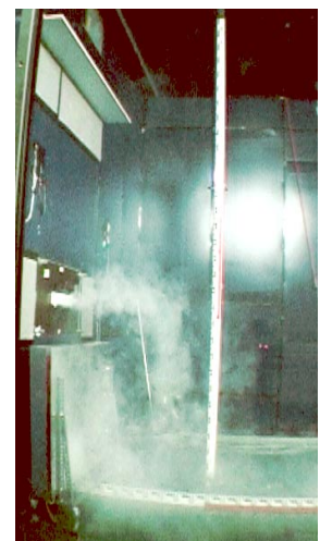
Figur 4-11: Heizkörper eingeschaltet (145 W), Strahl wird nach oben abgelenkt und stärker durchmischt. Das Zugluftrisiko wird kleiner, jedoch weiter in der Aufenthaltszone verlagert.
