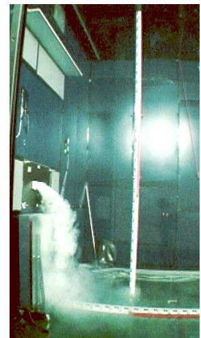
Figur 4-10: Heizkörper ausgeschaltet, kleine Diskomfortzone nahe beim Durchlass
