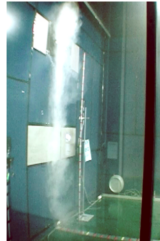
Fig. 7: Dieser ALD Typ weist eine relativ kleine Diskomfortzone auf, da der Luftstrahl nach oben und unten umgelenkt wird (Prallplattenprinzip), Wärmequelle: FBH
