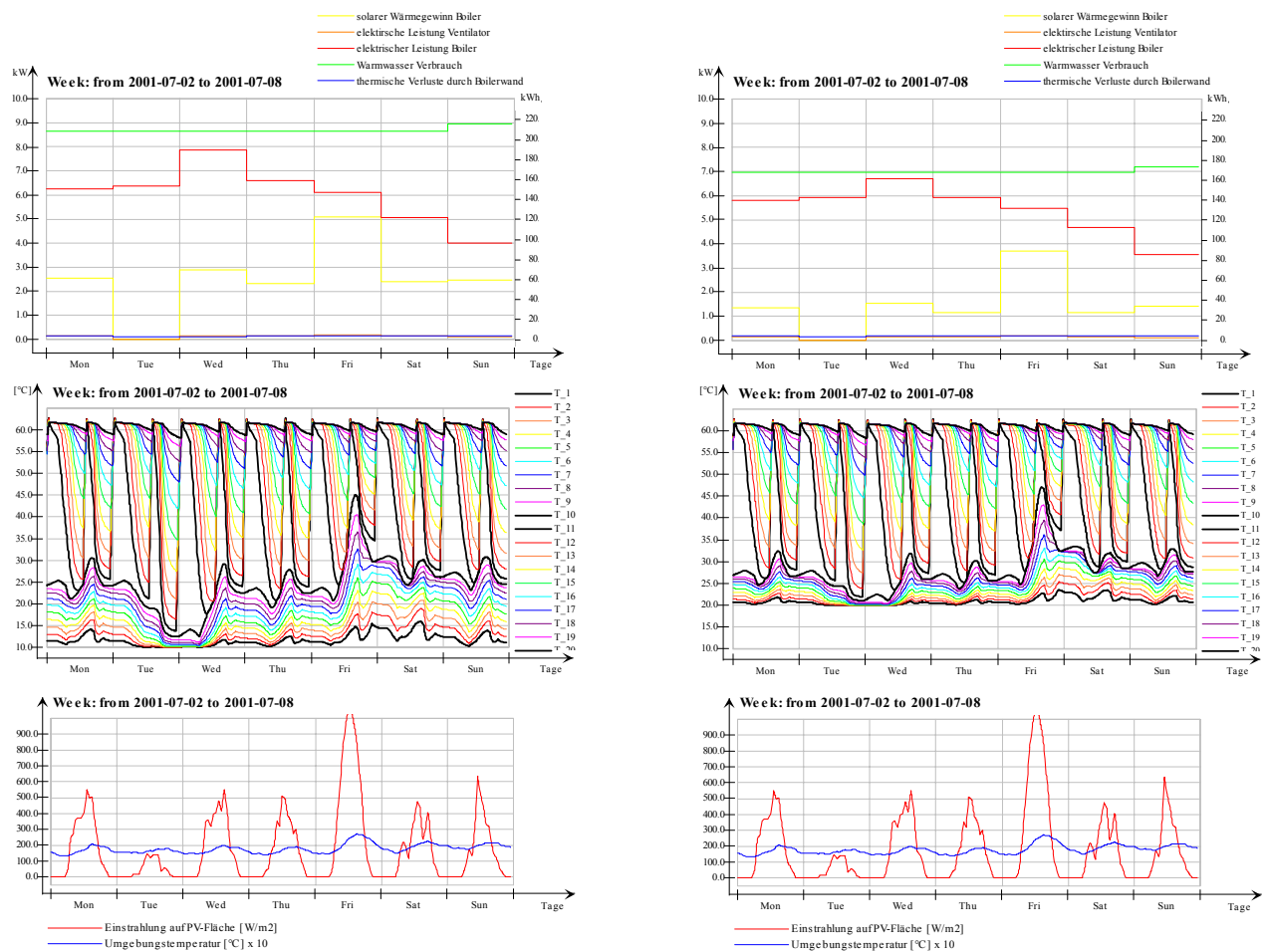
Fig. 23: tägliche Durchschnittsleistung der einzelnen Wärmeflüsse, Tagesverlauf der Schichttemperaturen im Speicher und zugehörige Wetterdaten für eine Juli-Wochen mit PV/T. Kaltwassertemperatur links 10°C (wie in Fig. 16b), rechts 20°C.
