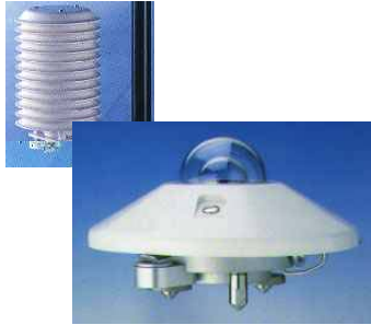
Fig. 12: Strahlungsschutz und Pyranometer
