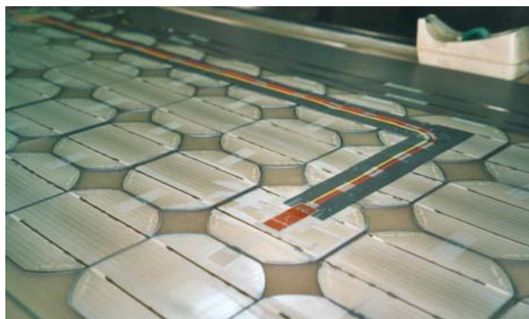
Fig. 4: PT-100 zur Messung der Zelltemperatur
