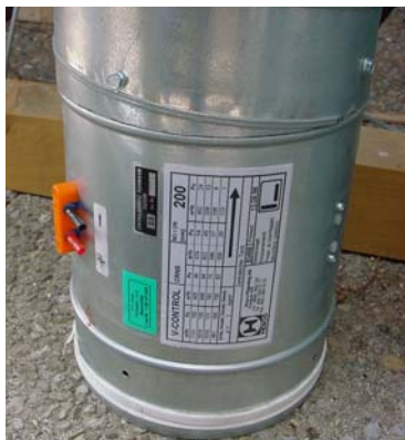
Fig. 15: V-Control zur Bestimmung des Luftvolumenstroms
