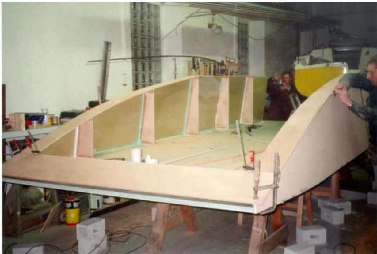
Bild 2 zeigt den Aufbau des Bootes um Mitte Dezember 2000 beim Glasfaserspezialist. Die Spanten aus Holz und die Klebefläche aus Sperrholz sind neben der grünen Grundplatte und den gelben Seitenplatten sichtbar. Auf der Seite der geschwungenen Frontpartie werden die speziell hergestellten rhombusförmigen Solarmodule in den mattenoxierten Alu-Rahmen gespannt und mittels Distanzklötzen vor dem Spritzen geklebt.
