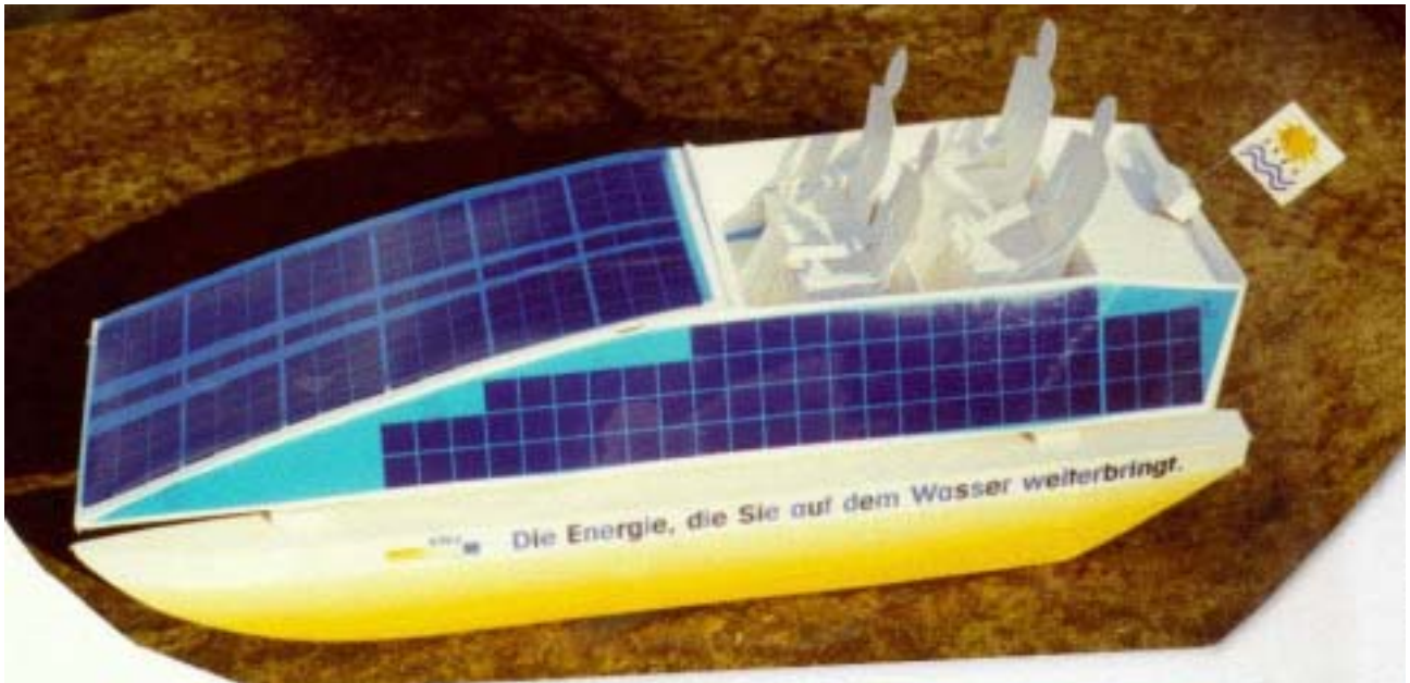
Bild 1 zeigt das Modell des Mietsolarbootes ZHolar im Masstab 1:20
