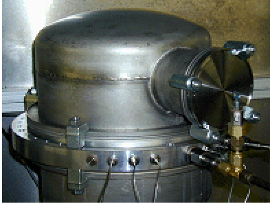
Fig. 6: Foto des oberen Teils des Sorptionsmoduls mit Messflansch sowie den Vakuumdurchführungen für die Temperaturfühler Pt 100 und das Wärmeträgermedium.
