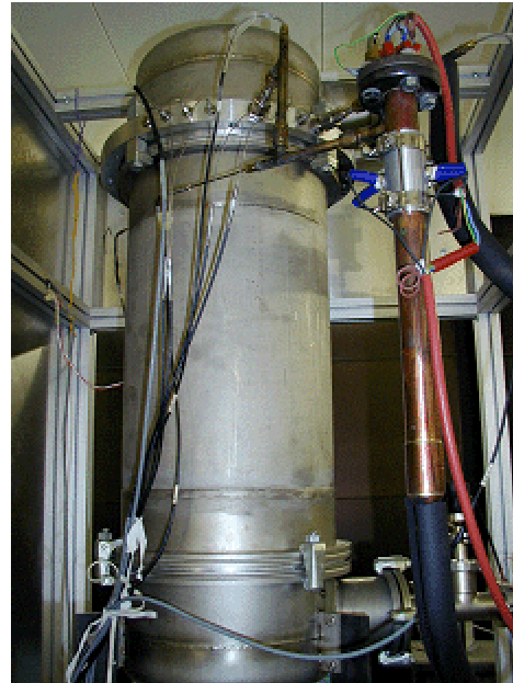
Fig. 3: Sorptionsmodul mit Messflansch (oben) und Fluidheizung (rechts). Der Durchmesser des Moduls beträgt 300 mm.
