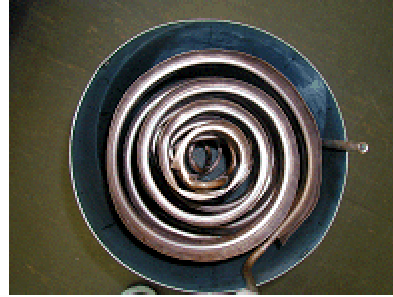
Fig. 7: Foto des Spiralfinen Wärmetauschers von oben. Die Oberfläche ist noch nicht auf ein hohes \epsilon behandelt. Dieser Wärmetauscher ist im Sorptionsmodul eingebaut.
