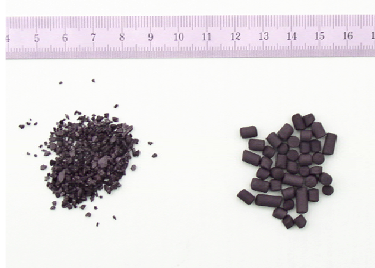
Fig. 6: Foto von Aktivkohle Granulat als Sorptionsmaterial, welche in Kombination mit Alkoholen als Sorbat eingesetzt werden kann, links W8x30-3, rechts L40-2 der Firma GUT Gesellschaft für Umwelttechnologie mbH, D-61169 Friedberg-Ockstadt.
