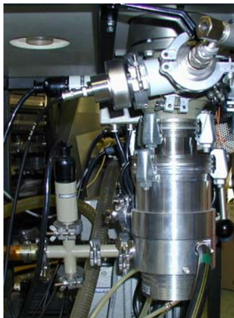
Fig. 2: Auf dem Bild ist der untere Teil des Sorptionsmoduls, die Verbindungsrohrleitung DN 40 (Mitte) und die Wasservorlage (unten) zu sehen.
