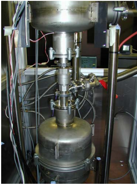
Fig. 2: Auf dem Bild ist der untere Teil des Sorptionsmoduls, die Verbindungsrohrleitung DN 40 (Mitte) und die Wasservorlage (unten) zu sehen.
