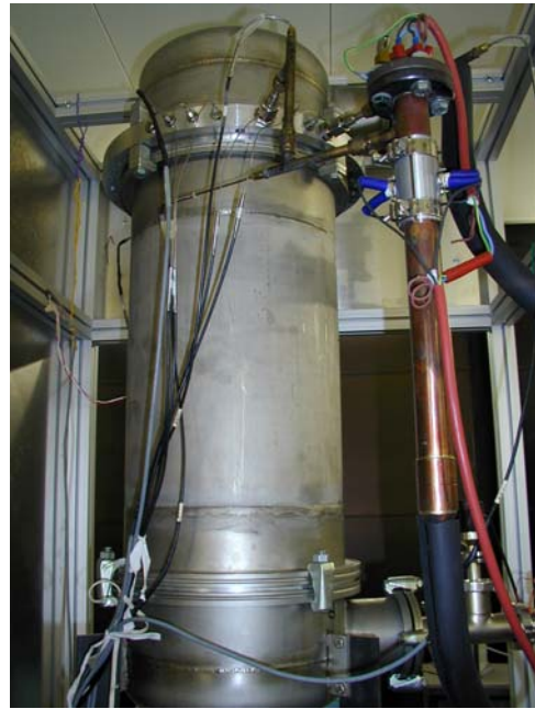
Fig. 3: Sorptionmodul mit Messflansch (oben) und Fluidheizung (rechts). Der Durchmesser des Moduls beträgt 300 mm.
