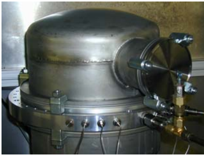
Fig. 6: Foto des oberen Teils des Sorptionsmoduls mit Messflansch sowie den Vakuumdurchführungen für die Temperaturfühler Pt 100 und das Wärmeträgermedium.
