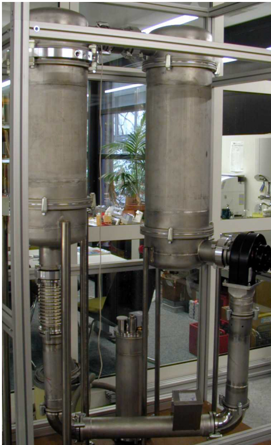
Fig. 1: Foto der Sorptionsspeicheranlage. Links ist das Sorptionsmodul, rechts der Wärmetauscher und der Ventilator. Unten befindet sich die Wasservorlage. Der Wärmetauscher und das Sorptionsmodul sind über zwei Rohrleitungen verbunden. Bild: SPF.
