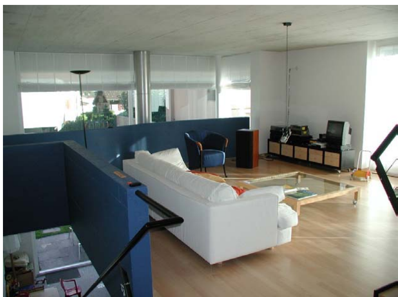
Fig. 3.4 Interno della casa Velti. L'importante quantità di massa termica interna è in contatto diretto con l'aria della casa, e assorbe in modo ottimale i guadagni solari passivi.
