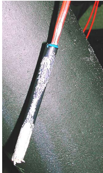
Abb. 8.3 Von Temper angegriffener Temperaturfühler
