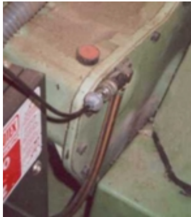
Abb. 3) Eine der zahlreichen undichten Schlauchkupplungen an einer Webmaschine. Weil die Maschinen dauern laufen und sehr laut sind, hört man kein Zischen.
