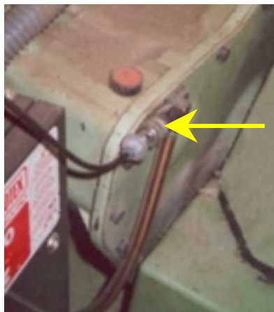
Abbildung 2) Undichte Steckkupplung für Druckluft an einer Webmaschine. Der Pfeil zeigt auf das Leck.
