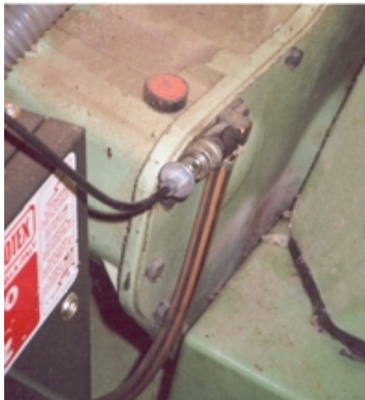
Abb. 2) Eine der zahlreichen undichten Schlauchkupplungen an einer Webmaschine. Weil die Maschinen dauern laufen und sehr laut sind, hört man kein Zischen (Foto Gloor).
