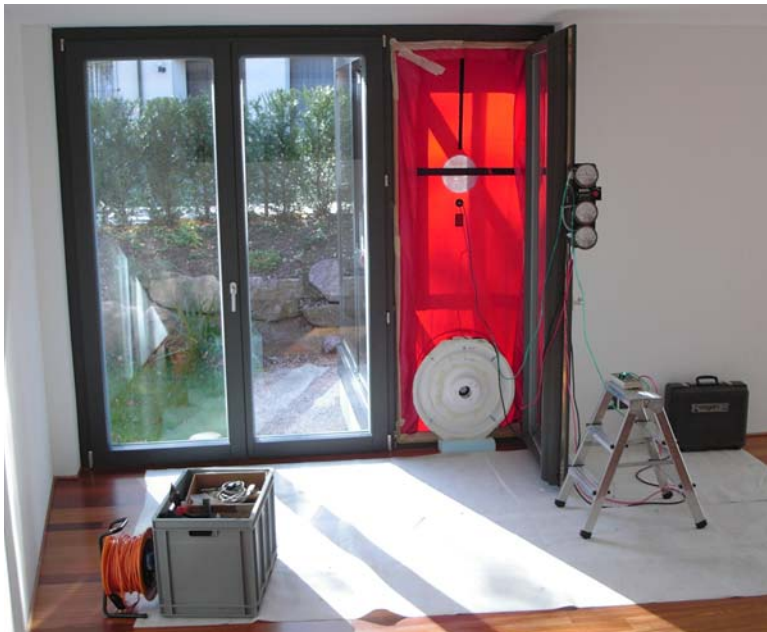
Fig. 1: Blower Door Messung im Passivhaus Piazza-Casa, in Biltzen Foto: ct176, EMPA
