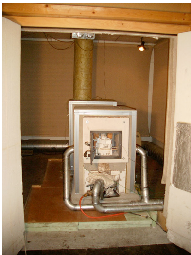
Abb. 4.2: Versuchsofen im Kalorimeterraum des Messlabors am Ökozentrum Langenbruck
