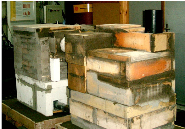
Abb. 4.1: Aufbau des VHP-Versuchsofens (Speicherofen mit Brennkammer links und Satellit rechts)
