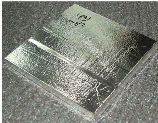
Fig. 1: VIP-Paneele für den Baubereich bestehen aus einem nanoporösen Kernmaterial (normalerweise pyrogene Kieselsäure) mit niedrigem Innendruck und einer möglichst gasdichten Hüllfolie (meist laminierte Aluminiumfolie oder metallbedampfte Kunststofffolie) mit verschweissten Rändern.
