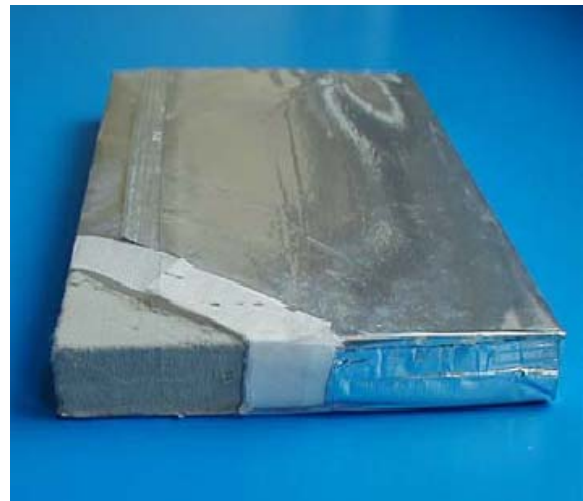
Figur 1: Vakuum-Isolations-Paneele (VIP), 5 bis 8 mal leistungsfähiger als konventionelle Dämmstoffe
