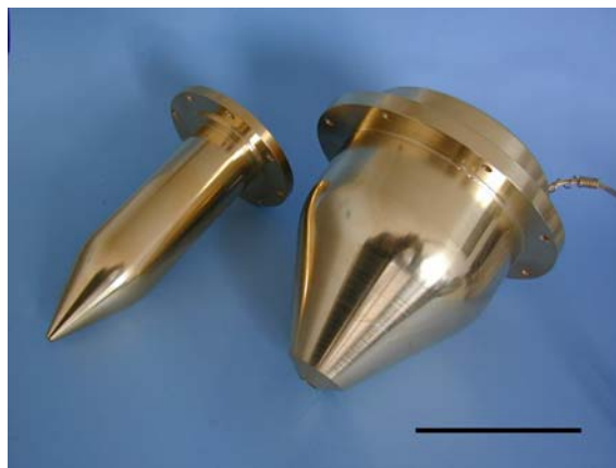
Fig. 2: Ringdüse zusammgebaut von vorne (links). Der schwarze Punkt im Zentrum entspricht der Düse, durch welche Zinkdampf austritt. Der Ringspalt für den Sauerstoff ist als dunkler Ring sichtbar. Im Bild rechts ist die Düse demontiert gezeigt. Die Zinkdüse (Bauteil links) wird in das Bauteil rechts eingeschoben und bildet so den Ringspalt für den Sauerstoff. Der Balken im Bild entspricht 10 cm.
