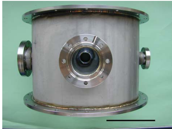
Fig. 1: Gesamtansicht von Rekin (links) auf dem Wagen. Die Gasvorheizung sowie die thermische Isolation im Bereich des Ofens (oben) sind noch nicht montiert. Messkammer ohne Fenster (rechts). Die coaxiale Düse wird auf Höhe des Zentrums des Fensters montiert. Der Balken im Bild rechts entspricht 10 cm.
