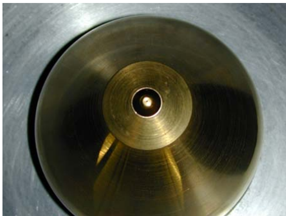
Fig. 2: Ringdüse zusammgebaut von vorne (links). Der schwarze Punkt im Zentrum entspricht der Düse, durch welche Zinkdampf austritt. Der Ringspalt für den Sauerstoff ist als dunkler Ring sichtbar. Im Bild rechts ist die Düse demontiert gezeigt. Die Zinkdüse (Bauteil links) wird in das Bauteil rechts eingeschoben und bildet so den Ringspalt für den Sauerstoff. Der Balken im Bild entspricht 10 cm.
