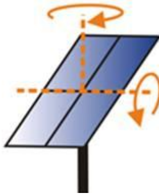
Abbildung 4: Achsen um welche der Kollektor der Sonne nachgeführt werden kann.
