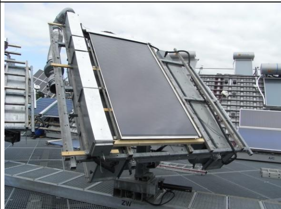
Abbildung 3 und 4: Einer der Kollektoren die Indoor und Outdoor vermessen wurden. Die Leistungskennzahlen sind für normale Flachkollektoren im Rahmen der Messungenauigkeit.
