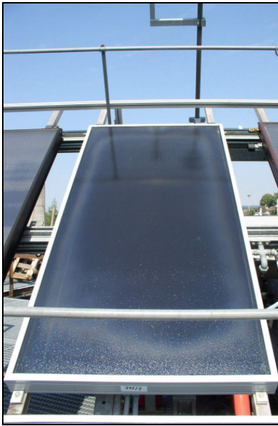
Abbildung-1: Starke Ausgasungen verursacht durch Wärmedämmmaterialien.
