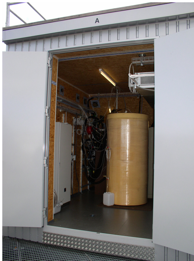
Abbildung-2: Das Bild zeigt die Rückseite des Systemteststandes. Die drei Testkabinen können über das ganze Jahr auf einer konstanten Temperatur gehalten werden. Die Teststände sind so aufgebaut, dass Systemprüfungen sowie Komponententests durchgeführt werden können. Das Kollektorfeld lässt sich bei Bedarf auch mittels elektrischer Heizpatronen simulieren. Die Wetterabhängigkeit von Komponententests kann so reduziert werden.
