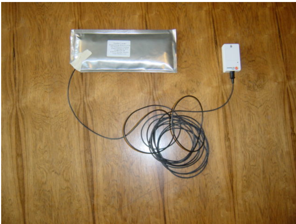
Vormessung 1 an einem PCM-Beutel Climsel 24 (Aussentemperatur und PCM-Temperatur)
