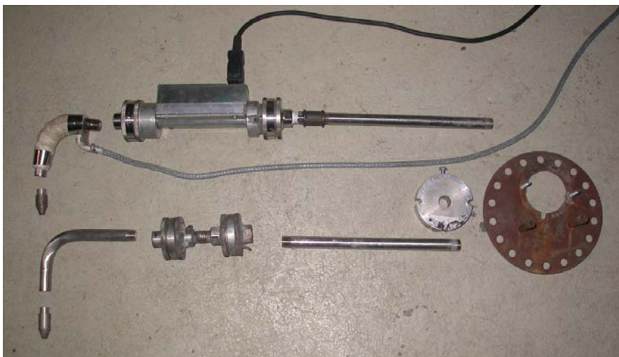
Abbildung 1 Isokinetische Probenannahme: oben beheizter Krümmer und beheizter Flachfilterhalter, unten die unbeheizte Variante. Rechts der Normflansch (EMPA-Standard) mit den weiteren Durchführungen für die Gasanalyse und das SMPS-System.
