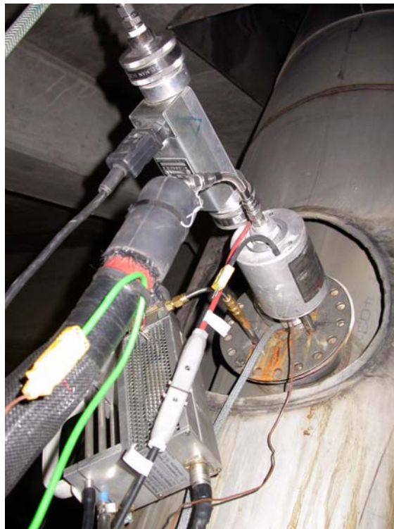
Abbildung 4 Proben- und Gasentnahme über EMPA-Flansch aus dem Kamin. Rechts die beheizte Gassonde der Gasanalyse, unten links verdeckt der Rotationsverdünner des SMPS-Systems, sowie zuoberst die beheizten Filterhalter der Gesamtstaub-Messung.
