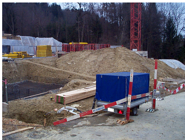
Figure 4 : Test de réponse en cours de réalisation. La bâche de la remorque est rabattue pour une meilleure isolation.
