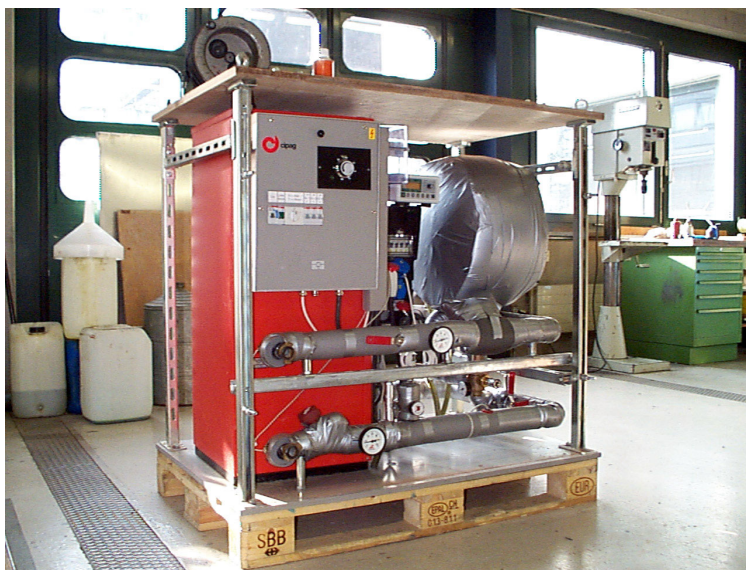
Figure 1: Vue du module de chauffage en cours de montage sur une palette CFF avec le cadre rigide de protection et l'isolation de la tuyauterie.
