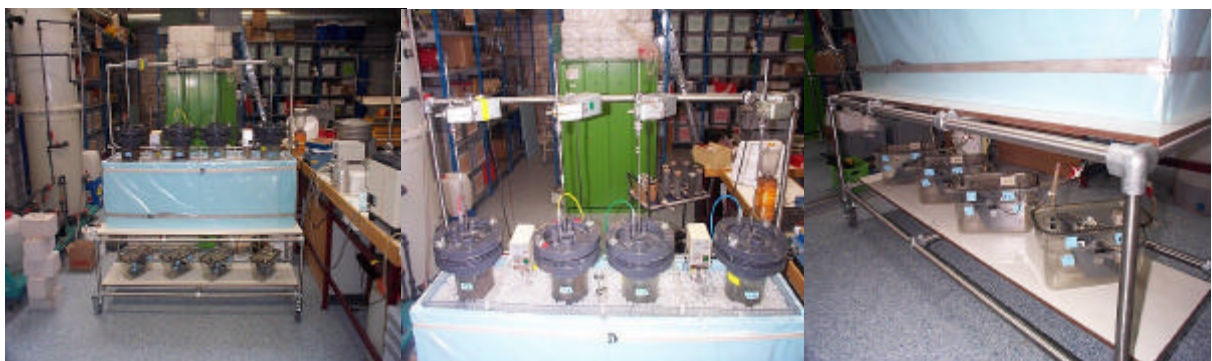
Abbildung 7: 4-strassige semikontinuierliche Biogasanlage
