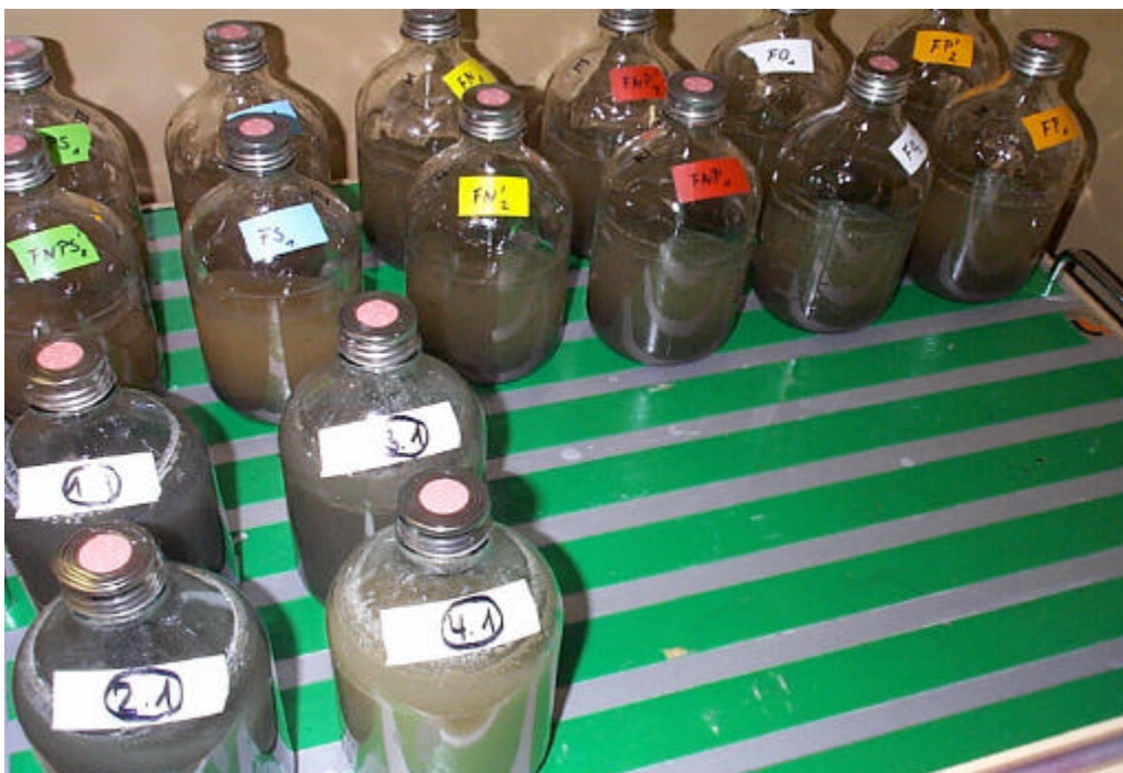
Abbildung 6: Anaerobe Batch Abbautests
